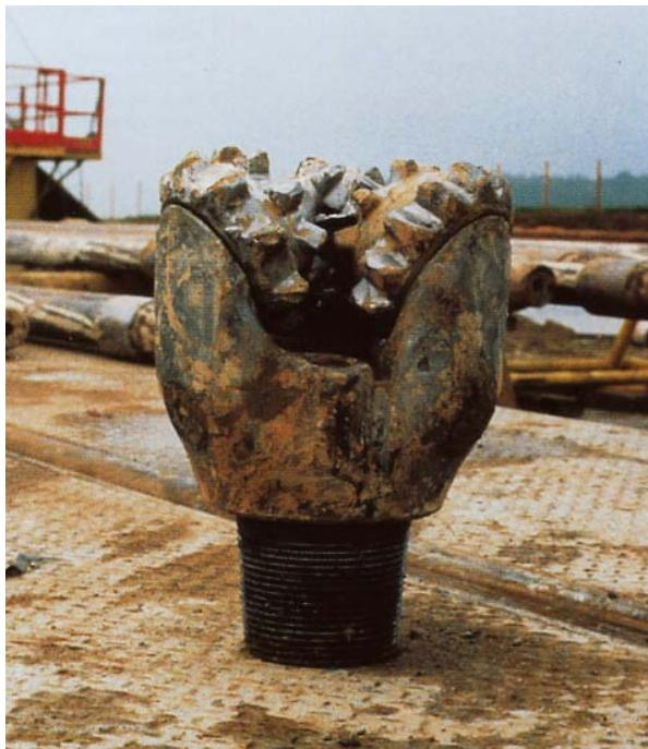
Der *Rollen-Meißel*. Er eignet sich zum Bohren in eher weichen Gesteinsarten. Auf drei Rollen sind Zähne aus speziell hartem Stahl angebracht, die das Gestein zertrümmern.
