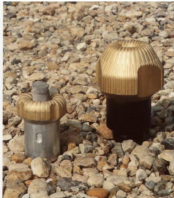
Der *Diamant-Meißel*. Er eignet sich für hartes Gestein. Der Bohrkopf ist mit künstlich hergestellten Diamanten besetzt. Er ist sehr teuer, zeigt aber einen relativ geringen Verschleiss.
